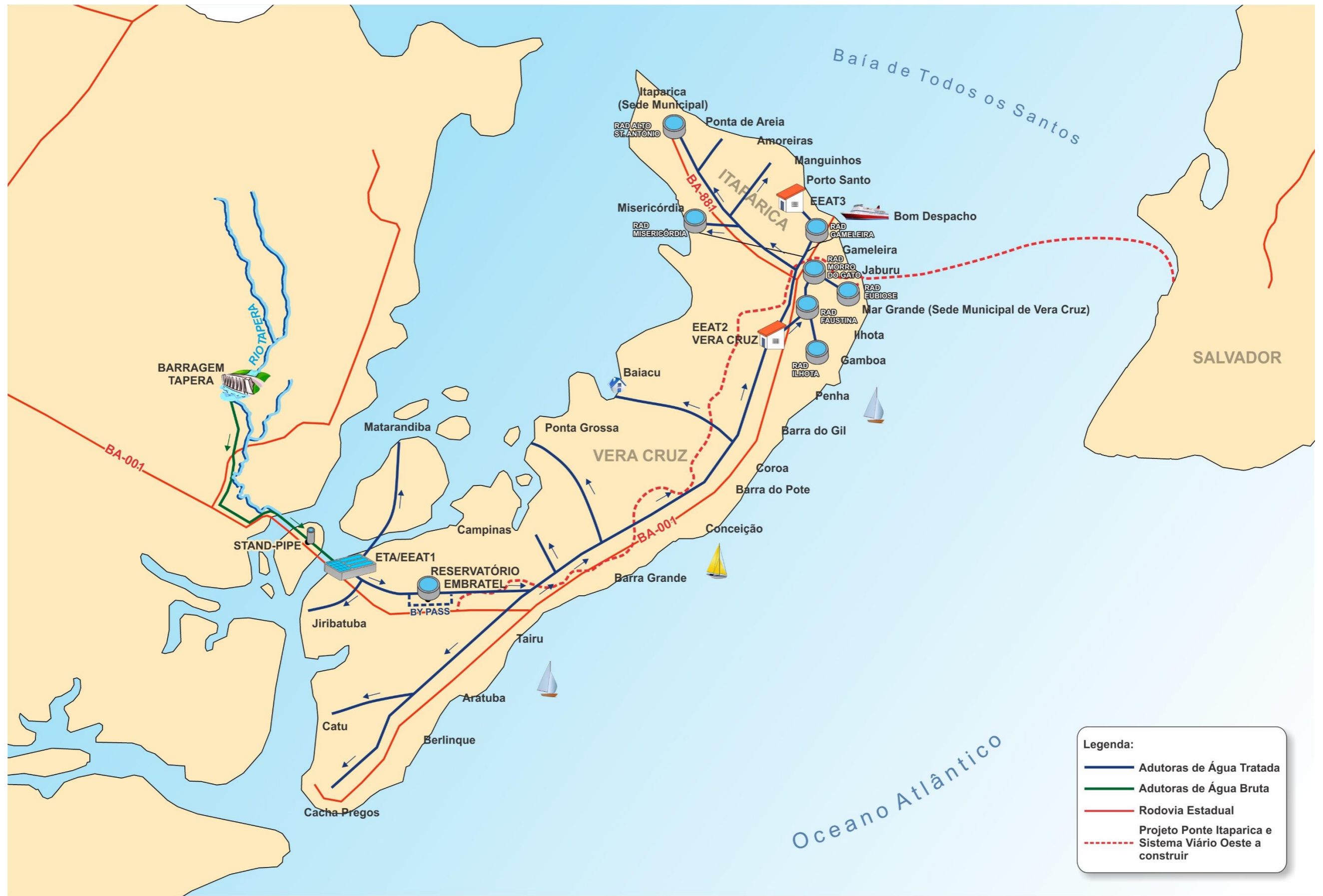
Figura 9.1 - Esquema geral simplificado do SIAA de Vera Cruz e Itaparica Fonte: Adaptado GEOHIDRO (2024).
