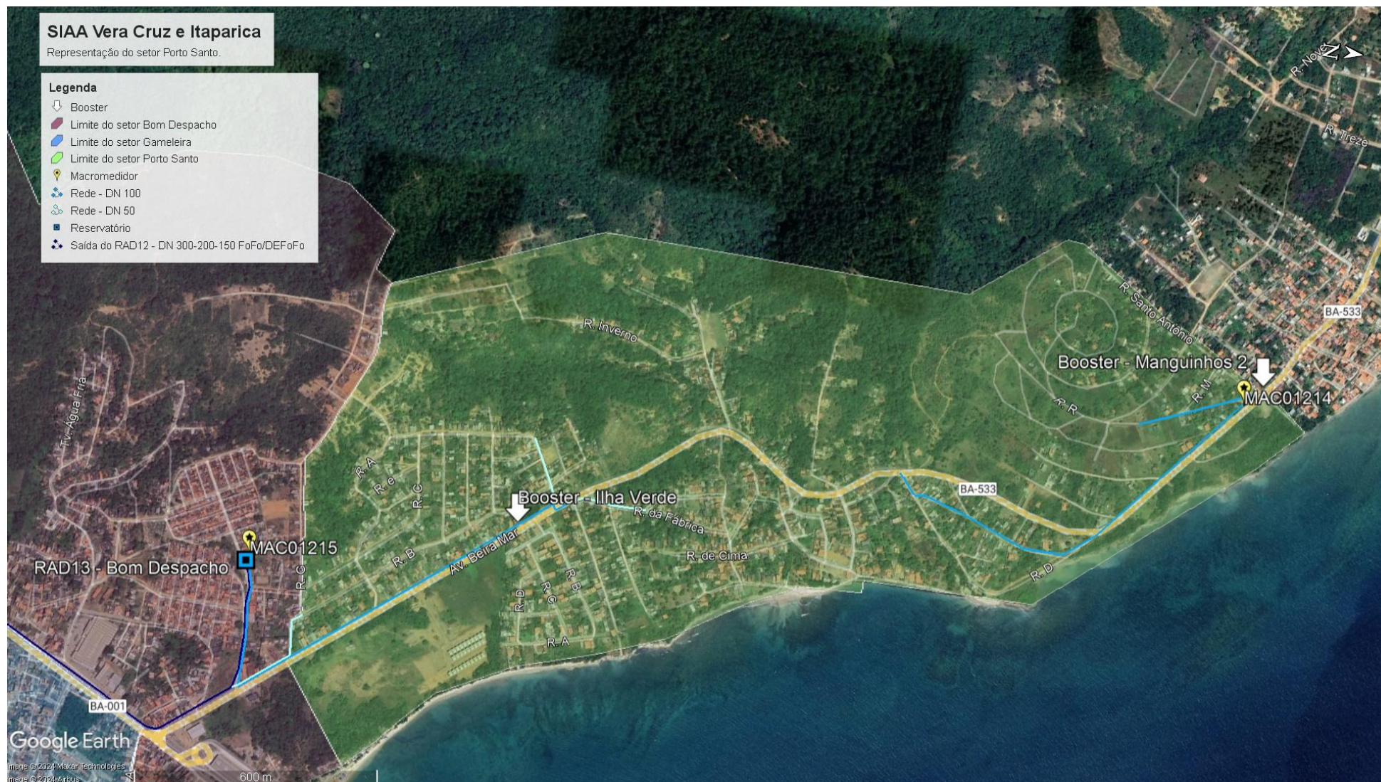
Figura 9.272 - Representação do setor Porto Santo – SIAA de Vera Cruz e Itaparica Fonte: Embasa (2024). Imagem: Google Earth (2024).
