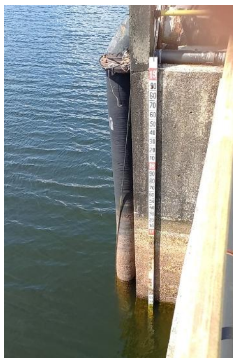
Figura 9.18 - Régua de medição do nível de água na torre de tomada d'água. Fonte: GEOHIDRO (2024).
