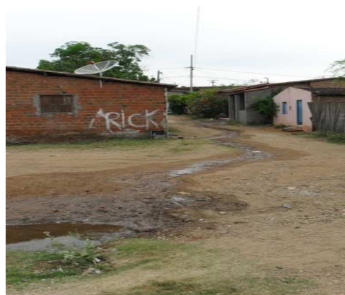
Foto 20: Águas servidas, convergindo ao riacho principal, advindas de setor não pavimentado e desprovido de tubulação coletora
