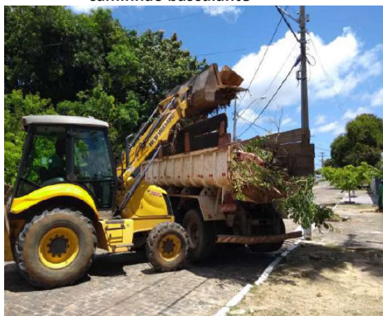
Foto 4.47 - Coleta dos resíduos de entulho, poda e limpeza corretiva com retroescavadeira e caminhão basculante
