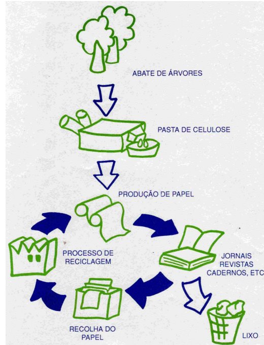
Figura 1.18 - Processo de Reciclagem do Papel
