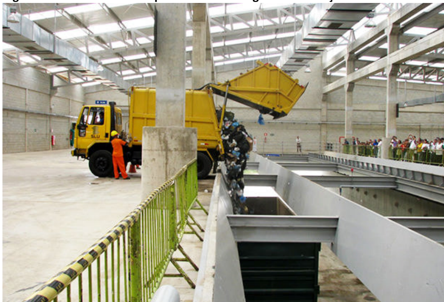
Figura 1.14 - Caminhão compactador descarregando na estação de transbordo
