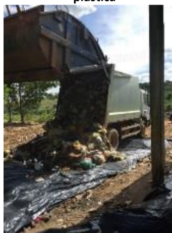
Foto 3.157 -Descarregamento do caminhão compactador sobre a lona plástica
