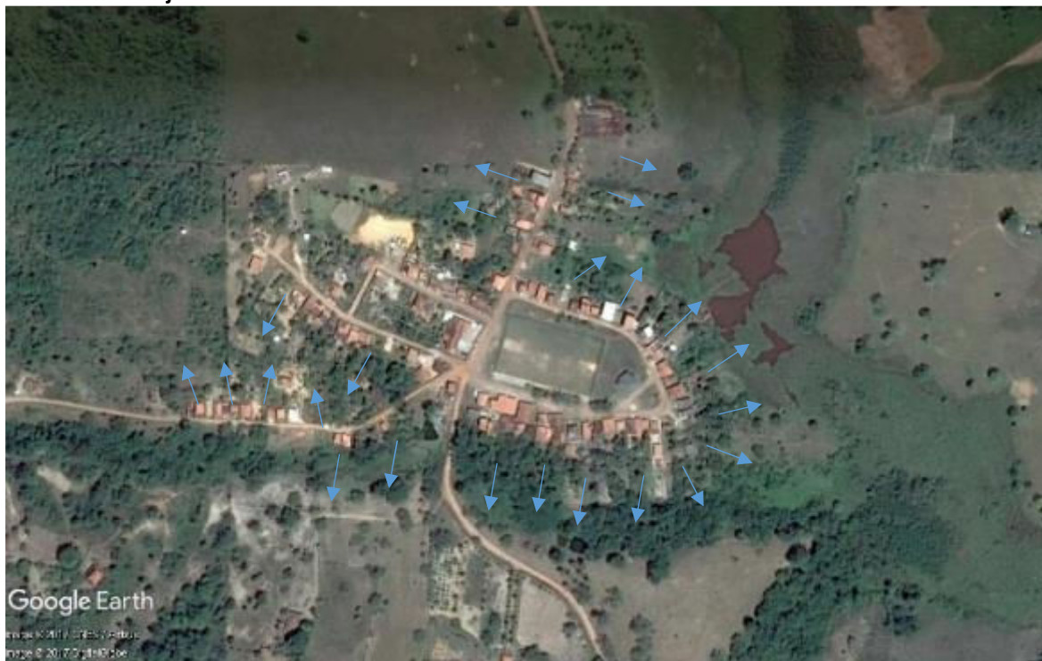
Figura 3.22 - Comportamento do lançamento irregular de esgoto – Povoado de Riachão – Distrito de Pojuca
