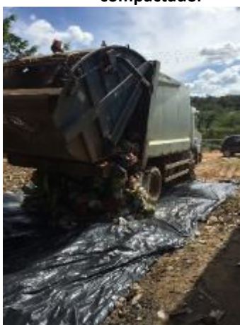
Foto 3.156 -Início da operação de descarregamento do caminhão compactador
