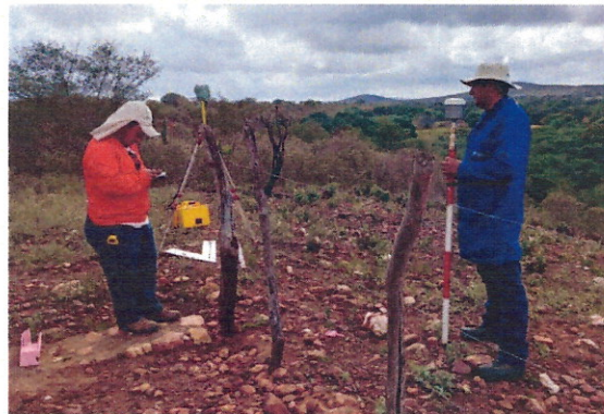
FOTO: POSICIONAMENTO DE BASE DO RECEPTOR GNSS
