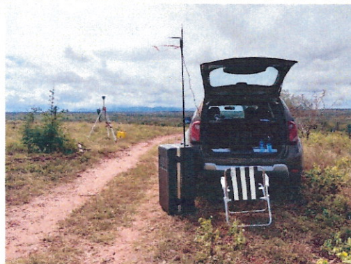
FOTO: BASE DO RECEPTOR GNSS E ESTAÇÃO DE APOIO COM ANTENA DE TELEMETRIA PARA MONITORAMENTO DE VOO DO DRONE
