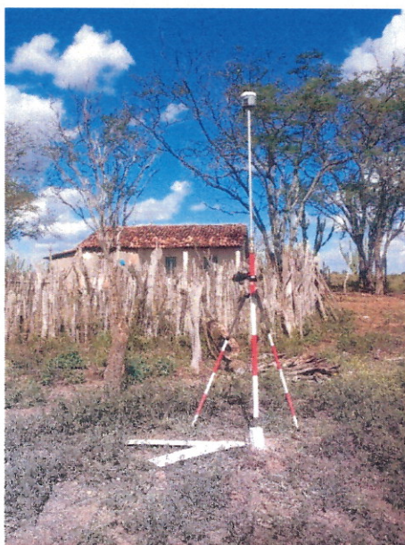
FOTO: IMPLANTAÇÃO DE MARCO EM CONCRETO, COM FLECHA DE PONTO DE CONTROLE PARA POSTERIOR IDENTIFICAÇÃO EM IMAGENS
