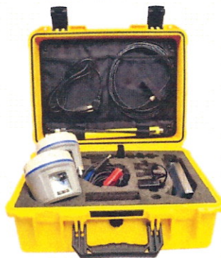
FIGURA: RECEPTOR CHC GNSS I80 COM 220 CANAIS, COLETORA CHC LT30 E ACESSÓRIOS.
