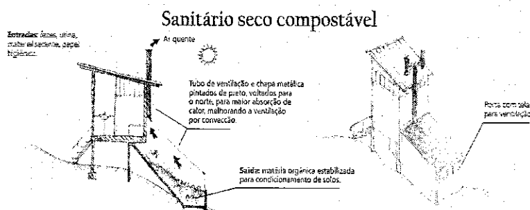
Figura 23 – Banheiro seco compostável – Esquema de implantação e exemplo
