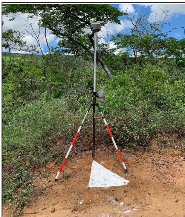
FIGURA 6 - COLOCAÇÃO DE PONTO DE CONTROLE (GCP)
