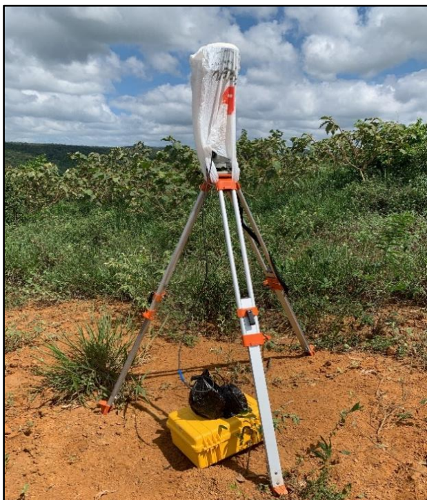
FIGURA 4 - BASE DO GNSS RTK
