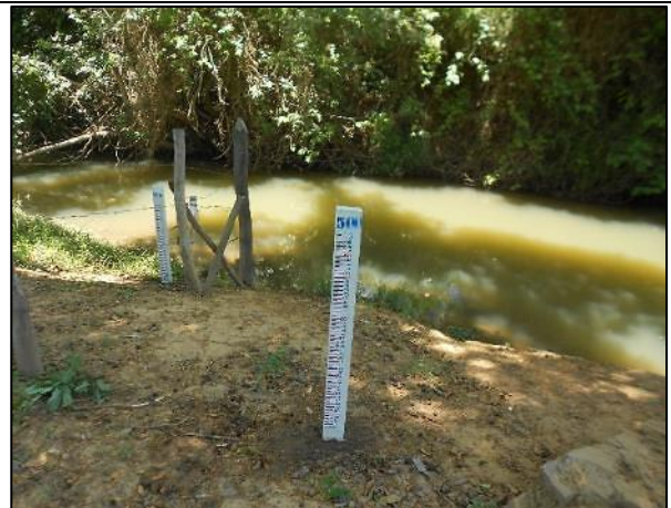
Vista geral das réguas linimétricas da estação
