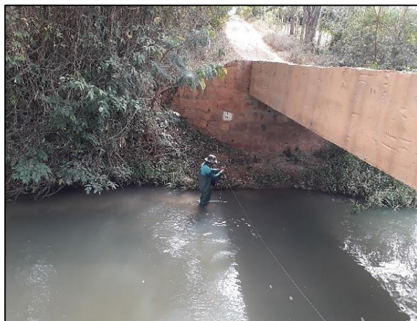
Realização da medição de descarga líquida
