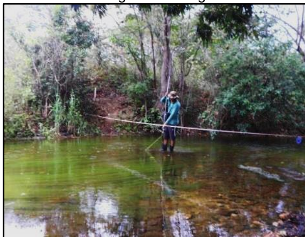
Medição de descarga líquida, deslocada da seção de medição
