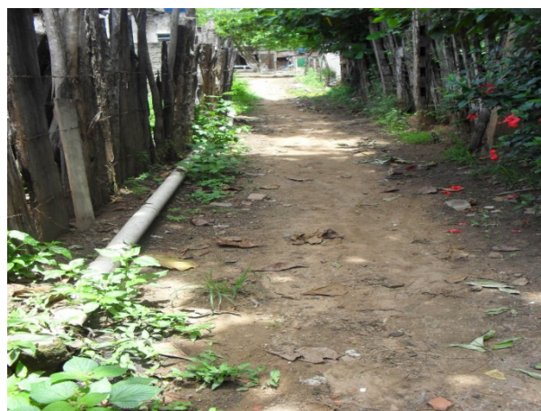
Foto 4: Residências localizadas a margem da principal via de acesso da cidade canalizam seus esgotos sanitários em até longos trechos para lançar no Rio Riachão.
