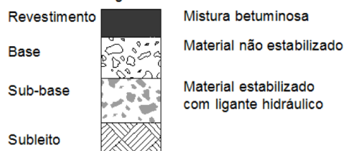
Figura 02 – tipos de pavimento semi-rígido (BALBO, 2007, p.52)
