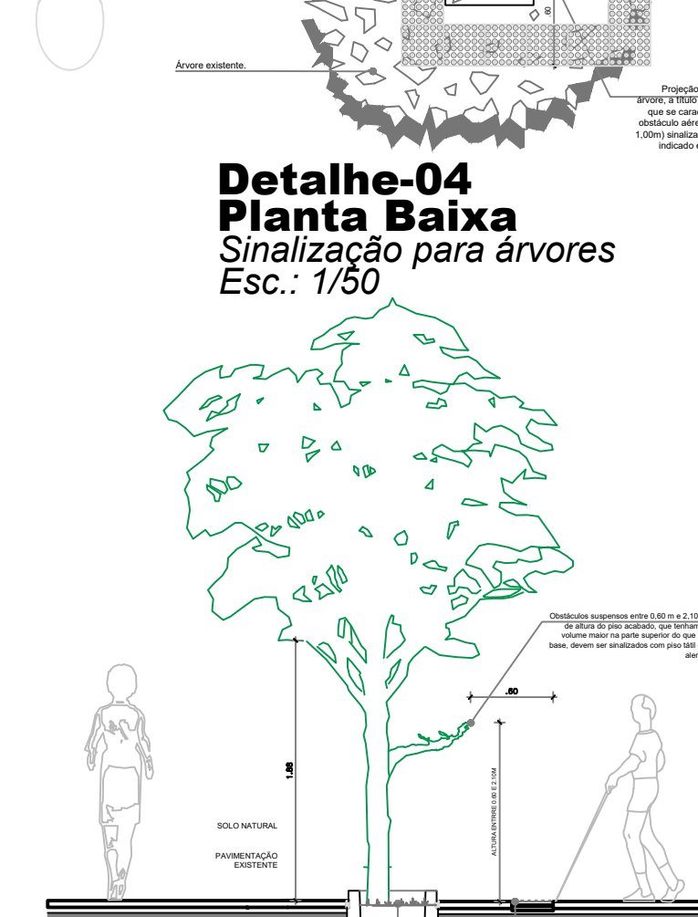
Detalhe-04 Sinalização para árvores - Vista frontal Esc.: 1/50
