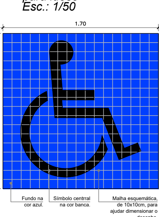
Detalhe-07 Pintura do símbolo intencional para acesso a P.N.E. Esc.: 1/25
